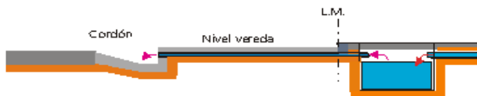
DISPOSICIÓN A CORDÓN (C/ TANQUE RETARDADOR)
