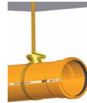
Sujeción simple de tubo Ø 110, fijando la cinta GrampaFlex a la losa, pasando por la hebilla.
