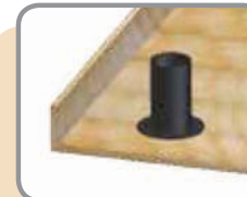
1. Ubicar el pase losa en el lugar requerido y enclavar en el encofrado.
