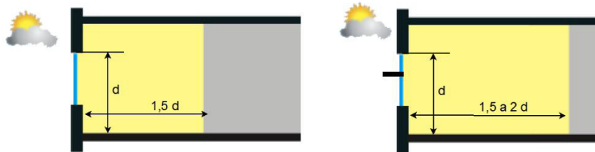
Figura 5.2.7 Profundidad de la luz natural.
