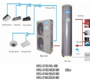
Figura 7.42. Esquema Bomba de Calor VRV multisplit.
