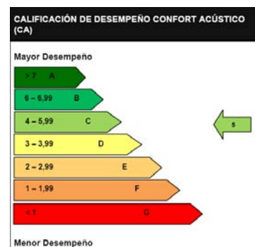
Figura 6.29. Sala 5 Escuela Francisco Valdés Subercaseaux, comuna de Curarrehue. a) Nivel de ruido: 36 dBA. b) Tiempo de reverberación: 0,48 s. c) Calificación Acústica: C (Buena).
