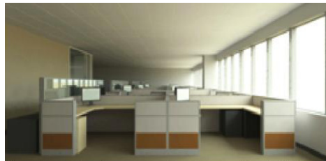
Paneles bajos favorecen la penetración de la luz
