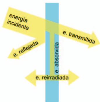
Figura 5.29. Esquema que muestra la energía incidente en un cristal, la energía reflejada, absorbida, irradiada y transmitida hacia el interior.
