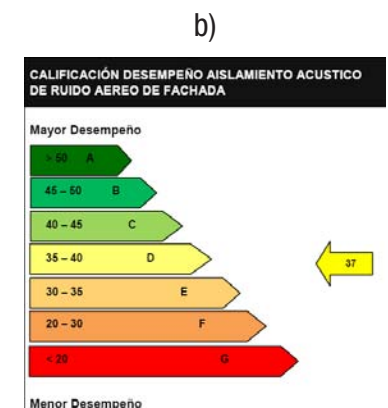
c) Figura 6.21. Fachada MOP Puerto Montt. a) Muro de hormigón armado, espesor 25 cm, más sistema de doble ventana. b) Aislamiento acústico: 37 dBA. c) Calificación Acústica: D (Moderadamente Buena).
