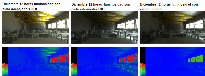
Figura 8.82. Imágenes de Radiance, permiten visualizar las variaciones de luminosidad con diferentes tipos de cielos al medio día durante solsticio de verano (21 de diciembre)
