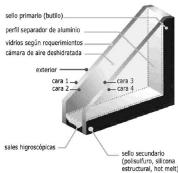
Figura 6.23. Un termopanel o Doble Vidriado Hermético (DVH) es un componente prefabricado compuesto por dos o más vidrios separados entre sí por un espacio de aire, herméticamente cerrado al paso de la humedad y al vapor de agua, lo que lo transforma en aislante térmico y acústico.
